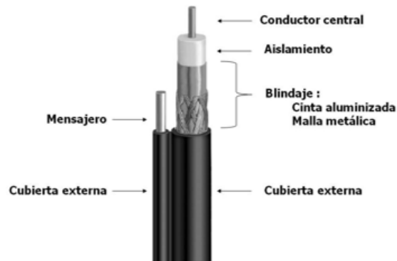
Componentes de un Cable Coaxial con Mensajero
